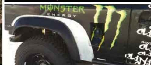
L'allungamento del passo ha richiesto anche lo spostamento dell'arco passaruota, con ricostruzione di una porzione di carrozzeria, e la prolunga delle protezioni sottoporta tubolari in acciaio.
