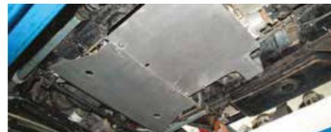
Cambio e riduttore sono protetti da piastre di duralluminio da 5 mm progettate da Clinic Car e realizzate dalla GM Taglio laser di Monsano (AN).
