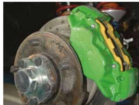
Sul ponte posteriore sono stati applicati dischi di maggiore diametro (i posteriori della 110 TD5), forati e baffati, accoppiati alle pinze a 4 pistoncini che vengono montate di serie sul ponte anteriore della Defender (le posteriori originali sono a 2 pistoncini).
