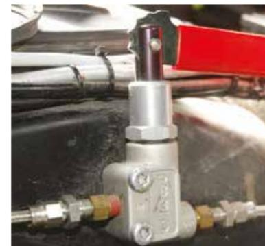
Sul tunnel tra i sedili è fissato il regolatore della frenata manuale. Un rubinetto, invece, permette di tenere in pressione il circuito frenante delle ruote posteriori, agendo così da freno di stazionamento o come sistema antiartramento nelle partenze delle prove.
