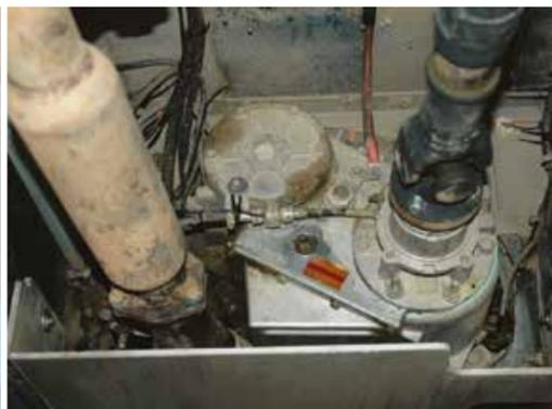
Il riduttore LT230 è stato dotato del set di ingranaggi Ashcroft che accorcia il rapporto delle marce normali (1,667:1). Inoltre il differenziale è stato rinforzato con ingranaggi e cross pin rinforzati dell'Ashcroft. Per risparmiare peso, il tamburo del freno di stazionamento all'uscita posteriore del riduttore è stato eliminato. A fare da freno di stazionamento c'è un rubinetto che, all'occorrenza, chiude il circuito dei freni sulle ruote posteriori.
