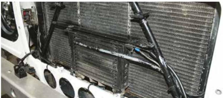
Il radiatore di raffreddamento del motore è l'originale del 3.5. Davanti è stato aggiunto un radiatore dell'olio motore, preso da una Land Rover 90 con motore 2.5 diesel aspirato. L'impianto è integrato da spruzzatori di acqua, pescata dalla vaschetta dei tergicristalli/fari, che vengono azionati manualmente all'occorrenza per pulire le masse radianti dal fango ma anche per migliorare il raffreddamento in situazioni di maggiore stress come le salite.
