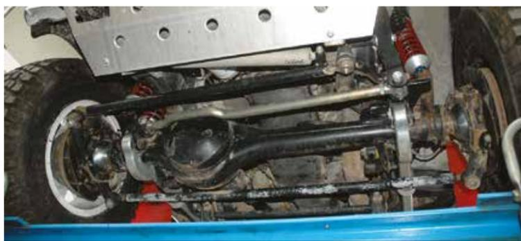
Sia la Panhard che le barre di sterzo sono rinforzate. La scatola dello sterzo è quella di serie, però dotata del pitman arm dritto della Discovery prima serie. L'ammortizzatore di sterzo, maggiorato e rinforzato, è stato prodotto dalla ORAP appositamente per questa vettura.
