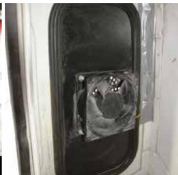
Sulla coda, al posto degli obli, sono state installati due pannelli con elettroventole che estraggono il calore dall'abitacolo e impediscono il rientro dei gas di scarico, migliorando nettamente la vivibilità a bordo.
