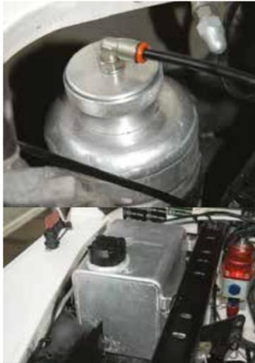
La vaschetta dell'olio dell'idroguida e quella di espansione del liquido refrigerante sono state rifatte in alluminio per una migliore dissipazione del calore. Quella di espansione è anche maggiorata.
