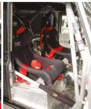
I sedili sono della OMP con cinture a 5 punti di attacco. La carrozzeria sotto i sedili e sopra il tunnel è rivestita con materiale ignifugo, che isola dal calore. Anche il cielo è coibentato con pannelli appositi.
