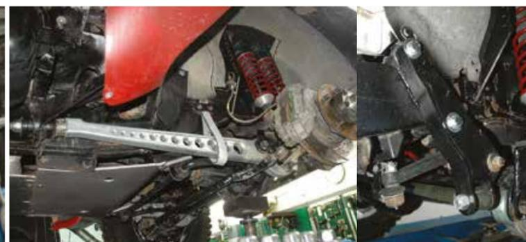
Anche il ponte anteriore è stato fatto avanzare, di 4 cm. Allo scopo sono stati utilizzati i puntoni speciali (con correzione del caster) e l'attacco avanzato della barra Panhard di Corsetti.
