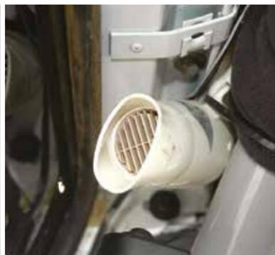
L'appannamento dei vetri in condizioni di elevata umidità è un problema ben noto sulla Defender. Il problema è stato risolto montando il parabrezza riscaldato della più recente edizione limitata della Defender e applicando due piccoli phon ai lati del parabrezza stesso, fissati al roll bar.
