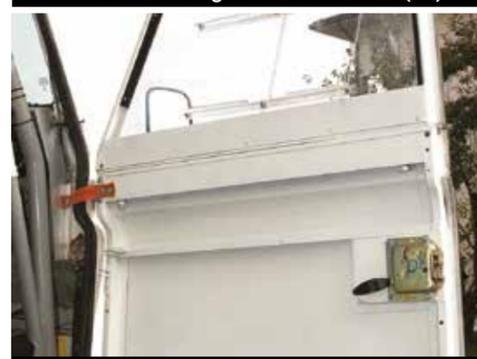
Per contenere i pesi sono stati adottati un cofano in vetroresina e le portiere della Land Rover Serie III, completamente svuotate all'interno (anche per migliorare il movimento del gomito sinistro del pilota) e dotate di finestrini in plexiglass.
