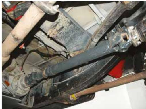
L'albero di trasmissione posteriore è stato allungato artigianalmente per adeguarlo al passo aumentato di 18 cm. L'albero anteriore è l'originale di una Defender 2.4 TD4, che è più lungo ed ha le flange più grosse.
