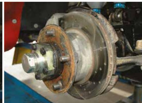
All'avantreno troviamo nuovi dischi autoventilati, quelli di serie della TD5, poi forati e baffati, con pinze sempre della TD5. L'impianto è gestito da un regolatore di frenata regolabile dall'abitacolo, reso necessario perché con le pinze maggiorate i freni posteriori frenerebbero troppo.
