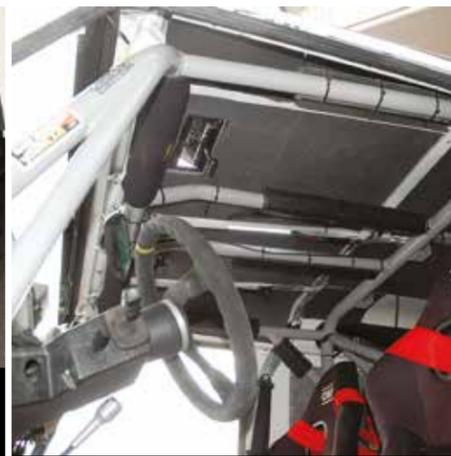
Il roll bar è stato costruito dalla Clinic Car secondo le norme tecniche FIA. Tutti i 6 montanti sono imbullonati, a livello del pianale, a delle staffe che a loro volta si fissano al telaio.
