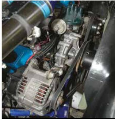
Il carter anteriore del motore, per semplicità, è stato sostituito con quello del 3.5. Pertanto anche la pompa dell'acqua, la ventola e la pompa del servosterzo sono del 3.5. L'alternatore è da 110 ampere. Il corpo dello spinterogeno è stato mantenuto solo per azionare la pompa dell'olio. La ventola con giunto viscoso originale è stata mantenuta perché risulta più potente delle elettroventole, che pure erano state provate.
