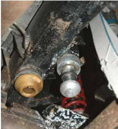
Al retrotreno sono stati adottati anche dei bump stop idraulici perché, volendo mantenere l'assetto più basso possibile, rimane poca luce tra telaio e ponte e di conseguenza si soffre molto di violenti colpi di fine corsa. In questo modo si può mantenere una taratura dell'assetto morbida senza patemi.
