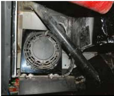
Il cambio manuale a 5 marce è un LT77S, dotato anch'esso di un radiatore dell'olio posizionato in un vano tra telaio e carrozzeria, davanti alla ruota posteriore sinistra, e necessariamente munito di una ventola elettrica, azionabile sia automaticamente sia manualmente dall'abitacolo.
