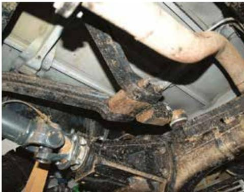
Per allungare il passo, il ponte posteriore è stato arretrato di 18 cm. Ciò ha richiesto una prolunga del supporto della testina del triangolo di guida superiore e la ricostruzione dei puntoni inferiori di lunghezza adeguata, tutto effettuato da Albanesi Microsaldature. Tutti i puntoni sono provvisti di cinghie di fine corsa, per evitare violenti strappi agli ammortizzatori sui salti (provengono da una Land Rover 88).
