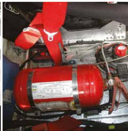
Come da norme FIA, la vettura è dotata di due impianti di estinzione: uno fisso, che si estende anche al vano motore (il relativo estintore è sul tunnel), e un estintore portatile.
