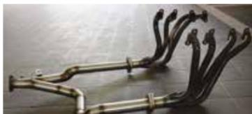
Lo scarico, in acciaio inox, è tutto nuovo: i collettori sono di tipo racing e tutto il resto è stato ricostruito. L'impianto prevede un solo silenziatore terminale.
