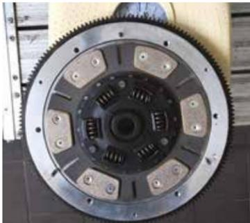
Il nuovo volano in lega leggera, che pesa solo 4,5 kg, e la nuova frizione sinterizzata hanno permesso di dimezzare il peso del gruppo (12 kg contro i 24 originali). Lo spingidisco è di una Defender 300 TDI, in grado di sopportare tutta la coppia del V8.
