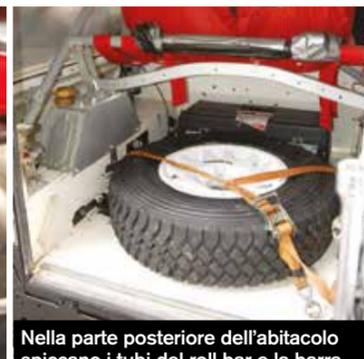
Nella parte posteriore dell'abitacolo spiccano i tubi del roll bar e la barra che collega i castelletti superiori degli ammortizzatori. Il serbatoio del carburante è quello originale, posto sotto il pianale sotto il sedile del passeggero. La vettura, però, è predisposta per l'alloggiamento di un serbatoio interno per gare di lunga durata.
