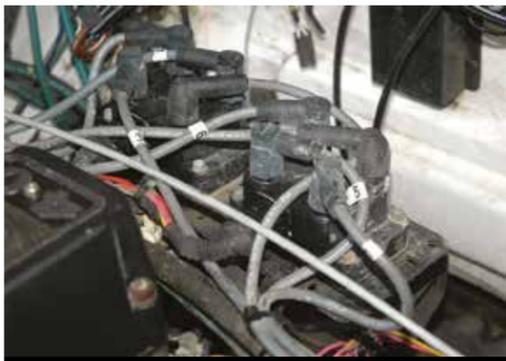
L'accensione avviene ora tramite due bobine Marelli di derivazione Lancia Delta Integrale.
